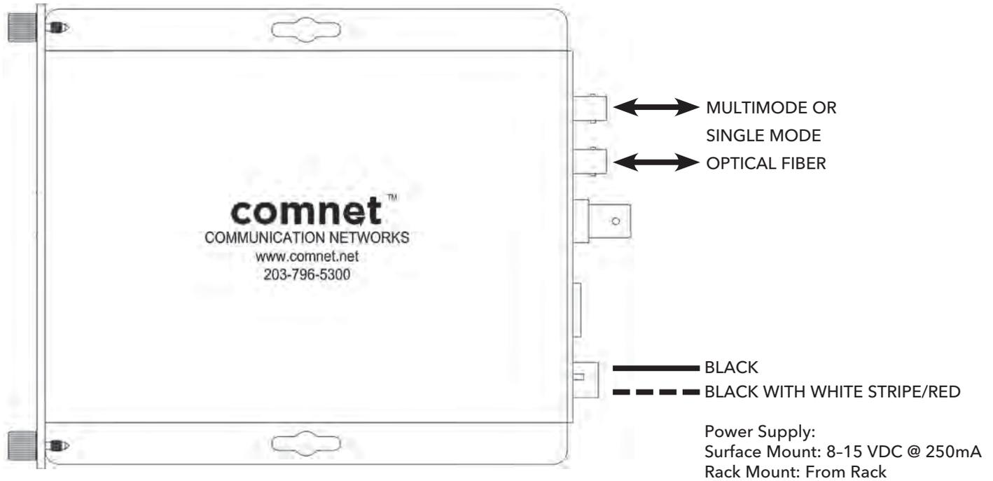
FIGURE 2 - FVT15M2 TRANSMITTER
